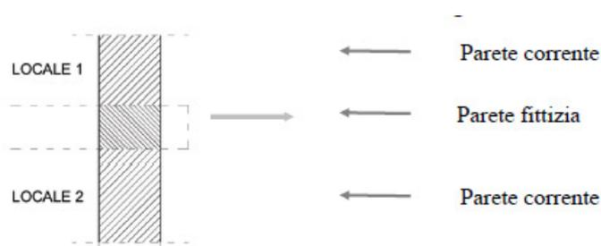
32. ponte termico e' la discontinuita' di isolamento termico che si puo' verificare in corrispondenza agli innesti di elementi strutturali (solai e pareti verticali o pareti verticali tra loro);
