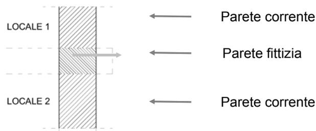
**ponte termico:** discontinuità di isolamento termico che si può verificare in corrispondenza agli innesti di elementi strutturali (solai e pareti verticali o pareti verticali tra loro).
