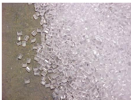
Cristalli di polistirene prima dell'espansione ed estrusione
