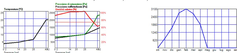
B) Analisi igrotermica stazionaria oraria. La valutazione è condotta in accordo con UNI EN ISO 13788, ma con passo orario anziché mensile. Dai grafici si evince la condizione climatica di umidità e temperatura per ogni interfaccia della parete (a sinistra un esempio) e l'accumulo orario nell'anno tipo (a destra).
