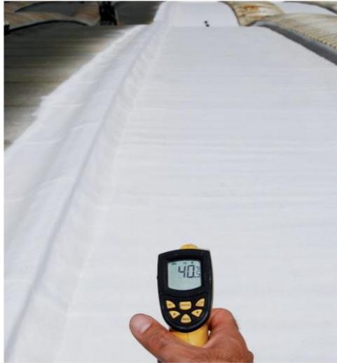
Temperatura del tetto dopo l'applicazione delle membrane liquide LAM
