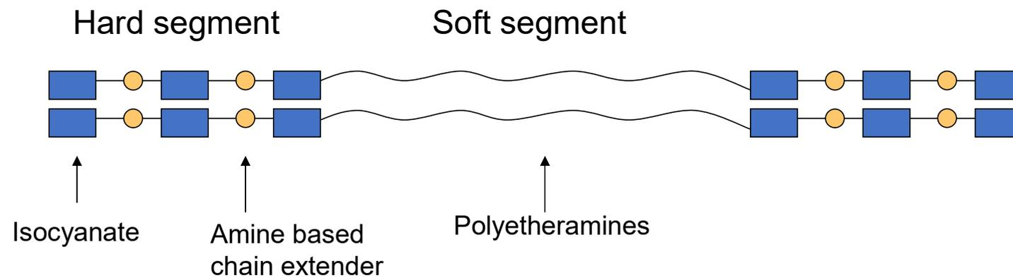
L'alternanza di segmenti rigidi e morbidi genera le caratteristiche finali dell'elastomero e ne permette l'utilizzo in diverse applicazioni
