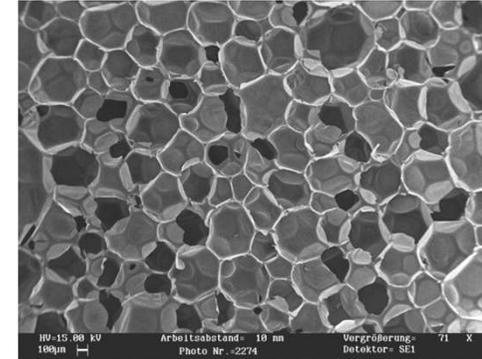
La schiuma poliuretanicca è sempre soggetta ad un naturale processo di invecchiamento dovuto allo scambio del gas contenuto nelle celle con l'aria.
