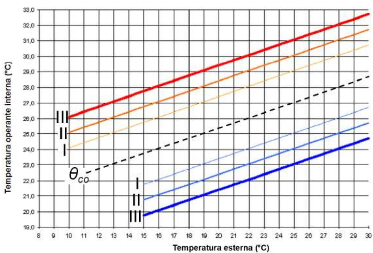
Il modello europeo. Nel grafico sono visualizzati i confini delle categorie di comfort I, II e III secondo la norma UNI EN 15251
