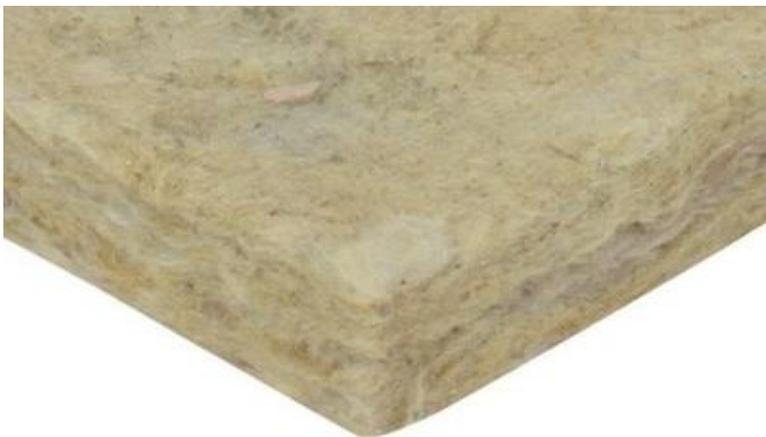
La lana minerale è un materiale costituito essenzialmente da fibre di roccia. Le sue buone proprietà di isolamento termico e acustico, unite all'incombustibilità, rendono la lana minerale un materiale ottimo in applicazioni nel campo dell'edilizia.
