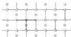
Figura 11 : Schema a T di tassellatura
