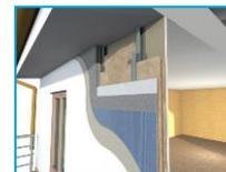
\*Sistema di isolamento termico a cappotto (ETICS, Exterior Thermal Insulation Composite System)
