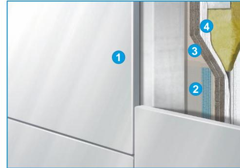
1. Rivestimento in alluminio con sottostruttura
