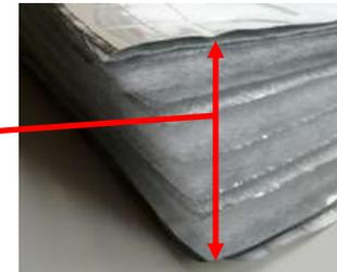
**3** calcolare la resistenza termica delle intercapedini d'aria ricavata secondo UNI EN 6946 in base a: emissività, spessore delle intercapedini e direzione del flusso di calore.
