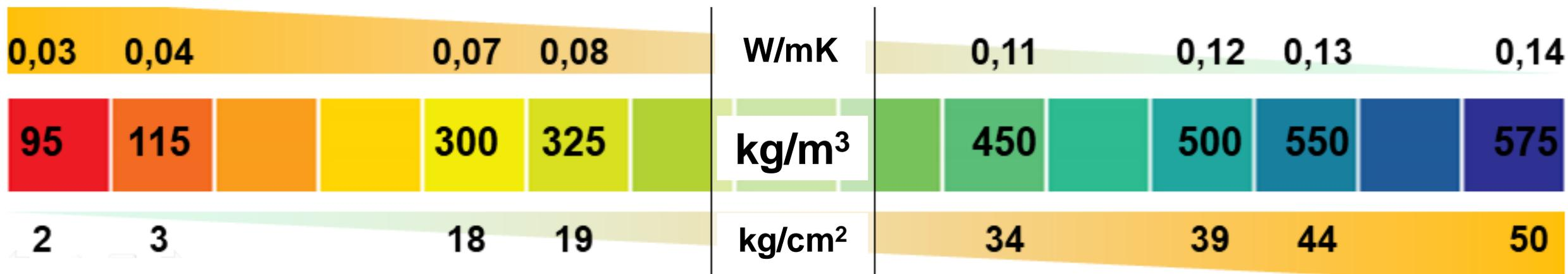
Al variare della densità del calcestruzzo aerato autoclavato, varia la caratteristica di resistenza meccanica (espressa in  $\text{kg/m}^3$ ) e di isolamento termico ( $\lambda$  –  $\text{W/mK}$ ) – più è leggero, più isolante.
