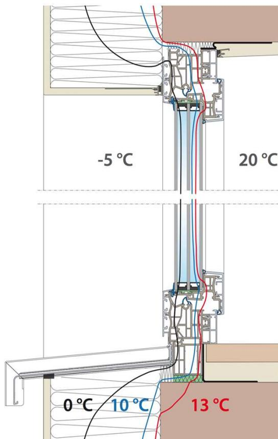
Per rendere più isolanti i telai in alluminio, altre aziende nel settore impiegano svariati inserti di isolamento. Noi abbiamo rivoluzionato completamente il serramento in alluminio, impiegando al centro un grande profilo in PVC dalle ottime proprietà termoisolanti. I vantaggi:
