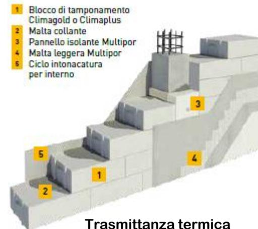
Trasmittanza termica fino a 0,15 W/m<sup>2</sup>K
