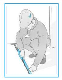
Applicare il nastro mono/biadesivo di guarnizione isolante in polietilene espanso sull'anima della guida, per contenere le trasmissioni acustiche laterali.
