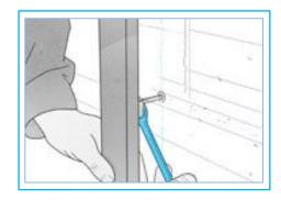
6. Tagliare i montanti "C Plus" della lunghezza pari alla distanza tra le guide diminuita di 15 mm per facilitarne l'inserimento nelle guide. Inserire i montanti all'interno delle guide e fissarli ai ganci
