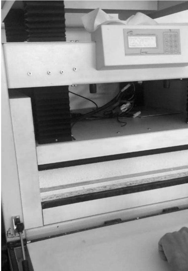
Valutazione della **resistenza termica R** e della **conducibilità termica  $\lambda$**  del sistema ETICS con il *metodo della piastra calda*, secondo UNI EN 12667.
