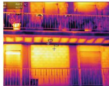
Facciata di edificio, \Delta T = 3.3 \text{ }^\circ\text{C} giugno, esposizione sud, ora di pranzo
