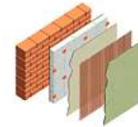
→ XELLA MULTIPOR 045 Sistema di isolamento per interni base di idrati di silicato di calcio
