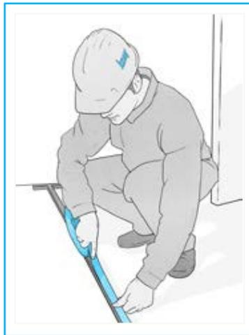
**4.** Applicare il nastro mono/biadesivo di guarnizione isolante in polietilene espanso sull'anima della guida, per contenere le trasmissioni acustiche laterali.
