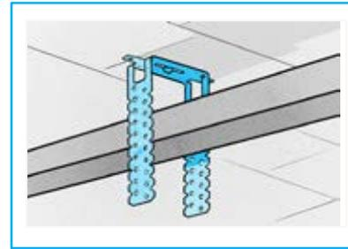
3. Per profili "C Plus" 50/15, 50/27 e 60/25, ancorato al solaio con la Vite di Congiunzione oppure il Distanziatore Universale che permette intercapedini sino a 12 cm
