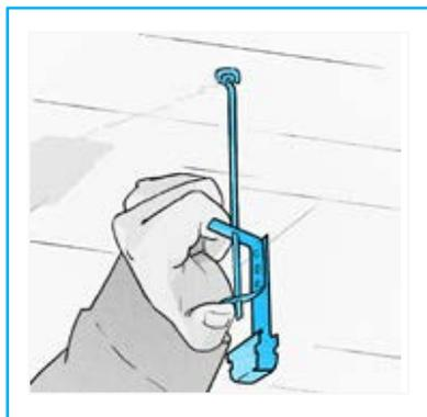
4. Se il ribassamento del controsoffitto è superiore ai 12 cm utilizzare come elemento di sospensione il Pendino diametro 4 mm per il Gancio con Molla per profili "C Plus" 50/15, 50/27, 60/25 la cui portata arriva a 25 kg
