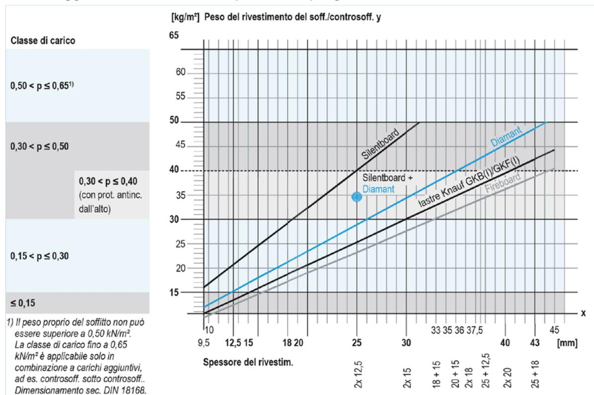
**FASE 1:** determinazione del peso del rivestimento del soffitto/controsoffitto in funzione dello spessore del rivestimento.
