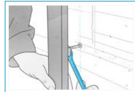
**6.** Tagliare i montanti "C Plus" della lunghezza pari alla distanza tra le guide diminuita di 15 mm per facilitarne l'inserimento nelle guide. Inserire i montanti all'interno delle guide e fissarli ai ganci
