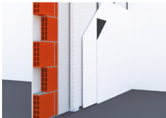
↑ Le contropareti vengono realizzate in ristrutturazione per aumentare il potere fonoisolante delle pareti esistenti.
