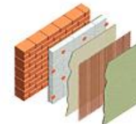
→ RÖFIX MINOPOR Sistema di isolamento termico a base di idrati di silicato di calcio
