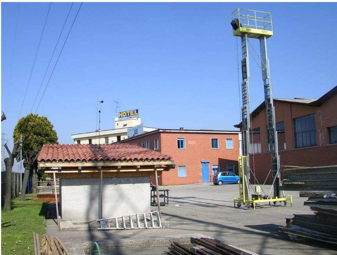
➤ **CAMERA DI PROVA ESTERNA in scala reale** per la valutazione delle prestazioni acustiche di coperture e falde per tetti (UNI EN ISO 16283-3)
