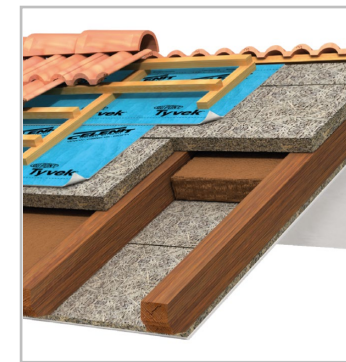
ISOLAMENTO AD INTRADOSSO PER LA RIQUALIFICAZIONE
