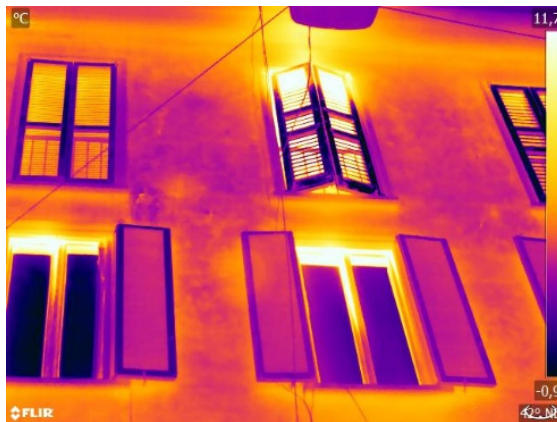
Ponti termici strutturali
