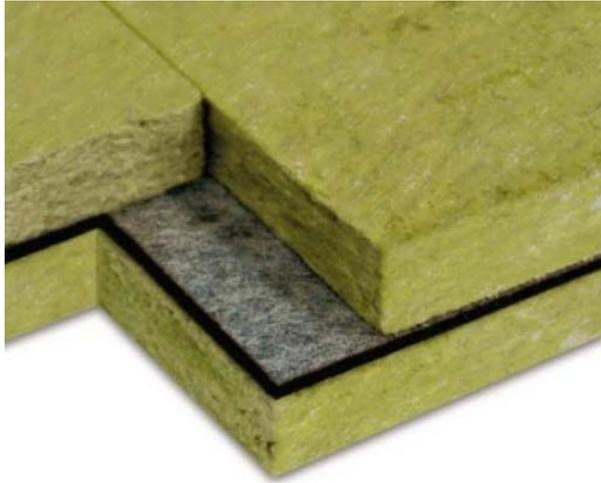
La presenza di due pannelli in lana minerale ad alta densità con interposta una massa plastomerica 7,5 kg/mq lo rende un pannello fonoisolante e fonoassorbente
