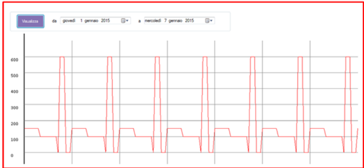
Figura 5: apporti interni – la schermata propone un valore dei carichi interni di default, ma lascia libertà all’utente di inserire un profilo più dettagliato (A) basato ad esempio su un ciclo giornaliero (B). I valori dei carichi interni sono espressi in W.
