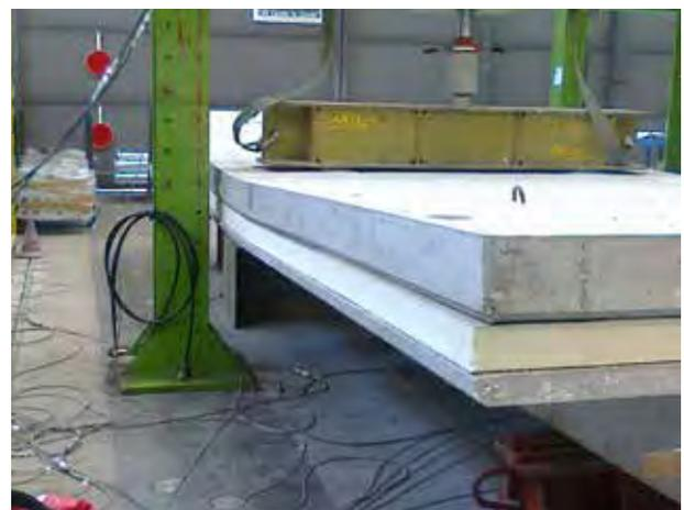
**Foto 6 e Foto 7** – Prova configurazione solaio  $\pi$  (pi-greco) (copertura industriale prefabbricata)
