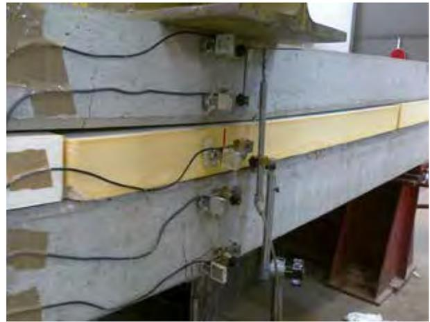
**Foto 4 e Foto 5** – Prova configurazione in semplice appoggio
