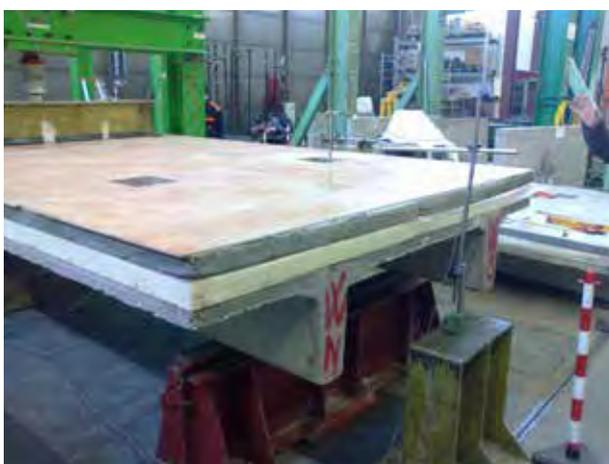
**Foto 10** – Prova configurazione solaio  $\pi$  (pi-greco) (solaio interpiano)
