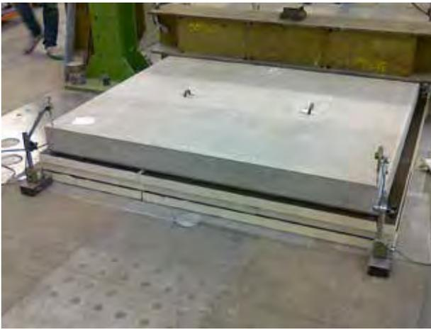
**Foto 1** – prova configurazione in appoggio totale
