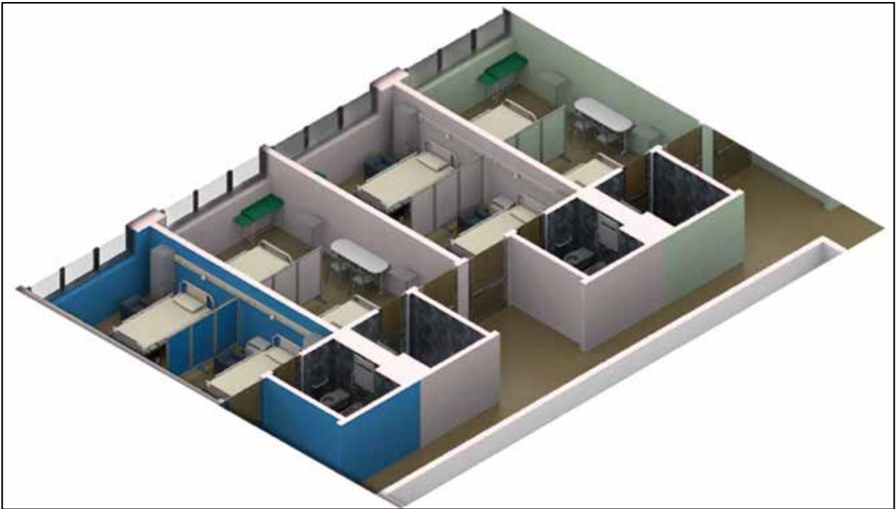
Figura 9 - ipotesi progettuale di diversa configurazione del vano di accesso alle camere di degenza per migliorare l'isolamento acustico dal corridoio.
