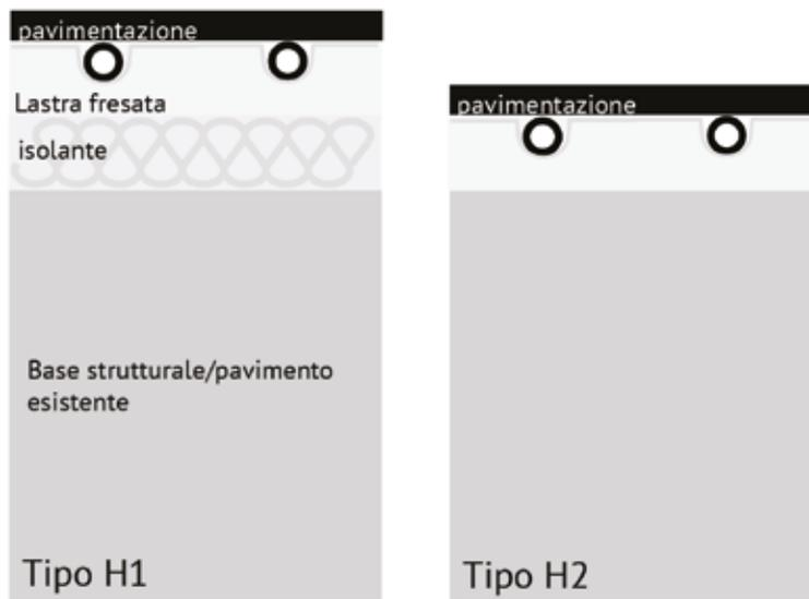
**Figura 4.** Esempi di sistemi radianti a pavimento di tipo H1 e H2
