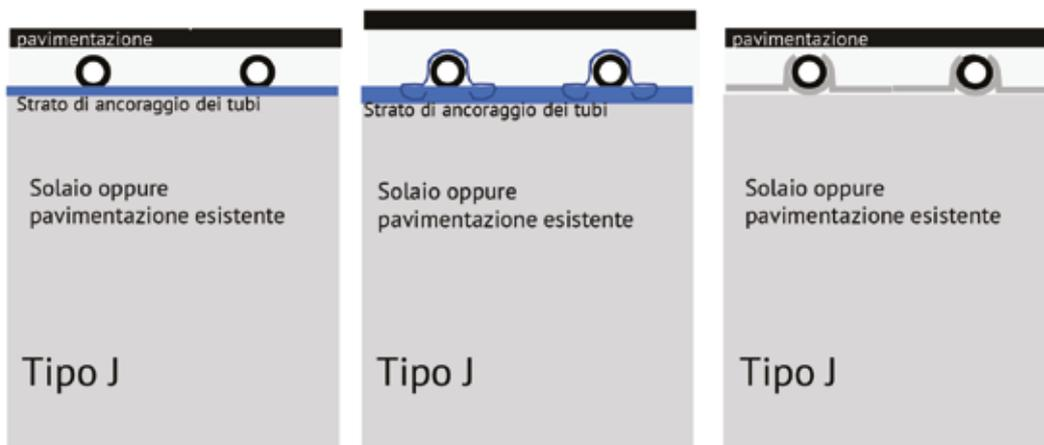
**Figura 6.** Esempi di sistemi radianti a pavimento di tipo J.
