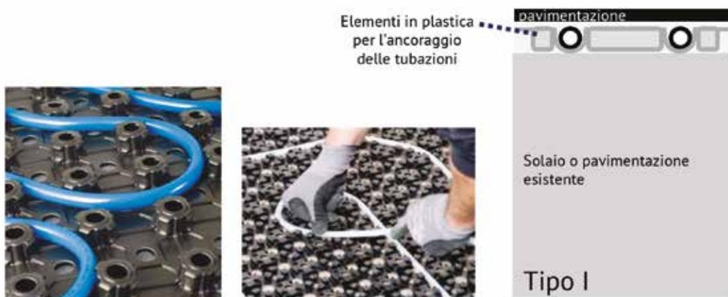
**Figura 5.** Esempi di sistemi radianti a pavimento di tipo I
