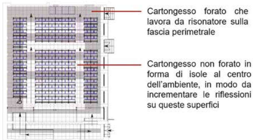
**Fig. 2:** Pianta del controsoffitto modulare. Le fasce grigie indicano i moduli trattati con materiale fonoassorbente mentre le restanti zone bianche indicano i moduli riflettenti non trattati.
