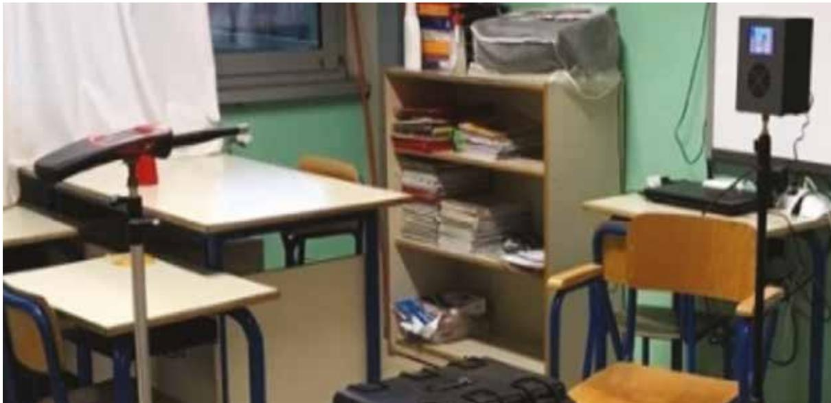
**Figura 3** – Strumentazione utilizzata per la misura diretta dello STI in un’aula campione; a sinistra il fonometro analizzatore, a destra la sorgente TalkBox.
