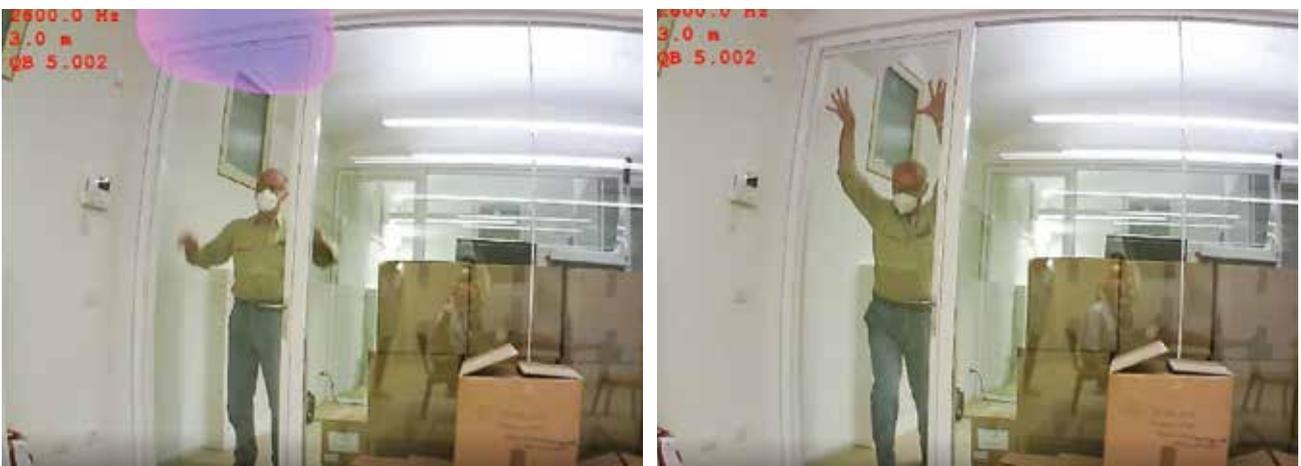
**Figura 6:** Problema sulla guarnizione di una porta: con porta chiusa (a sx) e con porta chiusa e pressione sul vetro (a dx)
