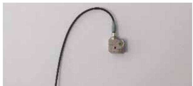
**Figura 10** – Accelerometro fissato al centro di una parete in muratura intonacata
