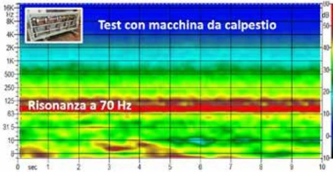
Lo spettrogramma rappresenta con scala cromatica i livelli di pressione sonora che si susseguono nel tempo. Sulle ascisse l'asse del tempo, sulle ordinate le frequenze. In rosso livelli di pressione sonora più elevati, in blu livelli minori. Si nota la fascia di colore rosso che presenta il livello più elevato. Negli spettrogrammi di destra è relegata a frequenze di circa 20Hz, misurabile dal fonometro, ma non udibile a livello umano.
