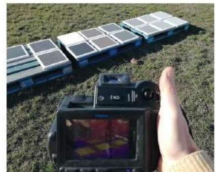
Figura 10: Macchina termografica impiegata durante le misurazioni e campioni.
