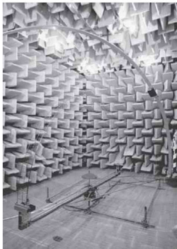
fig. 5 - Sistema di misurazione del coefficiente di diffusione in camera anecoica (ISO 17497-2:2012).
