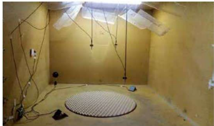
fig. 4 - Sistema di misurazione del coefficiente di scattering in camera riverberante in scala reale all'Istituto Nazionale della Ricerca Metrologica (INRiM) e in scala ridotta (1:5) al Politecnico di Torino (7).
