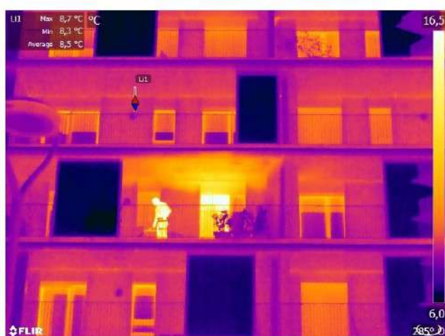
fig. 8 - Esempio di facciata con correzione dei ponti termici. La soletta in c.a. del balcone ha un elemento di taglio termico e quindi superficialmente la temperatura è omogenea ( \Delta T < 1 °C) come mostrato dai valori indicati dalla linea (massimo e minimo) - edificio realizzato a Milano - misure inverno 2022/23
