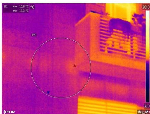
fig. 7 - Esempio di facciata con correzione dei ponti termici. La soletta in c.a. del balcone ha un elemento di taglio termico e quindi superficialmente la temperatura è omogenea ( \Delta T < 1 °C) come mostrato dai valori indicati nell'area circolare (massimo e minimo) - edificio realizzato a Milano - misure inverno 2022/23
