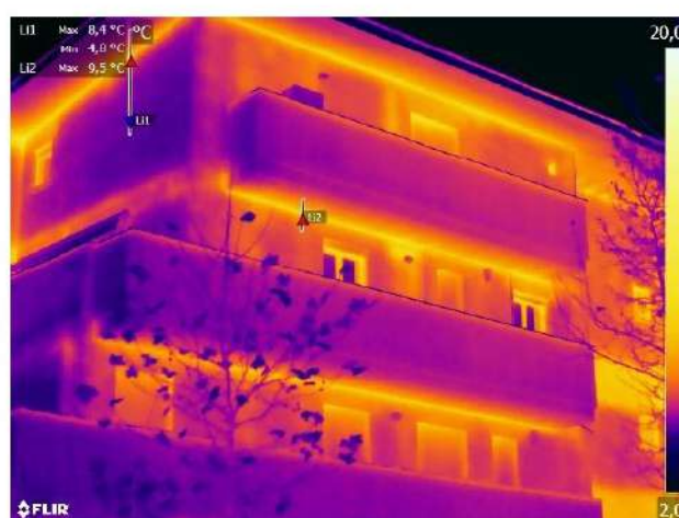
fig. 6 - Esempi di facciate con assenza di correzione dei ponti termici. La soletta in c.a. del balcone è direttamente a contatto con l'esterno ed è fonte di elevata dispersione termica
