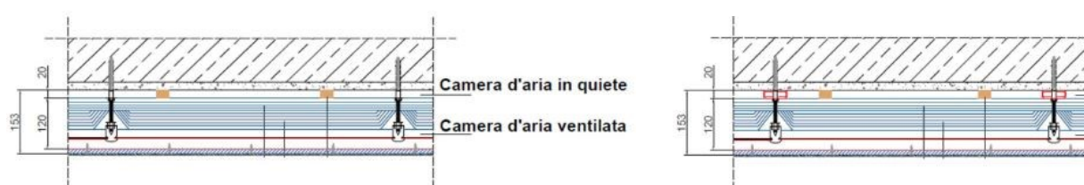
SEZIONI ORIZZONTALI (da sinistra a destra, senza e con tubolare opzionale a sezione rettangolare)
