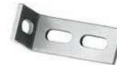
Staffa angolare a 90° in acciaio strutturale S235 zincato bianco, di giunzione con la barra anti ribaltamento, dimensione 90x45 mm, spessore 6 mm.
