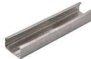
Montante in acciaio con rivestimento in lega di zinco-magnesio (Zn-Mg 120), certificato secondo la norma EN 10143 e EN 10346, spessore 6/10. La presenza dello speciale rivestimento in lega di zinco magnesio (composta dal 3,5% di alluminio e 3% di magnesio) comporta un'elevata resistenza alla corrosione anche in ambienti aggressivi. Installate orizzontalmente a scatto vanno a comporre l'orditura secondaria del sistema Isolareflex sulla quale verranno avvitati i pannelli in fibrocemento.
