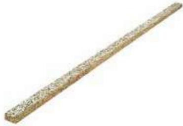
Listelli in lana di legno di abete rosso mineralizzati e legati con cemento Portland di dimensione 30x20x2000 mm. Ottenuti a partire da pannelli conformi alla norma UNI EN 13168, certificati ANAB-ICEA e PEFC, vengono utilizzati con funzione di distanziatori isolanti al fine di garantire un'intercapedine d'aria di 2 cm tra supporto murario e termoriflettente.
