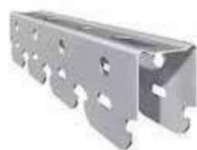
Guida a scatto in acciaio con rivestimento in lega di zinco-magnesio (Zn-Mg 120), certificato secondo la norma EN 10143 e EN 10346, spessore 8/10 di dimensioni 28x40 mm. La presenza dello speciale rivestimento in lega di zinco magnesio (composto dal 3,5% di alluminio e 3% di magnesio) comporta un'elevata resistenza alla corrosione anche in ambienti aggressivi. Installate verticalmente fissandole con apposito dado flangiato vanno a comporre l'orditura primaria del sistema Isolareflex.
