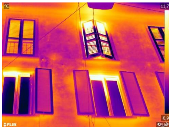
Ponti termici strutturali
