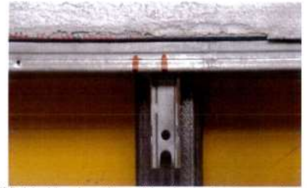
Figura 13: Particolare dello scorrimento del traverso alla base del campione rispetto al montante, evidenziato durante le prove quasi statiche e dinamiche.
