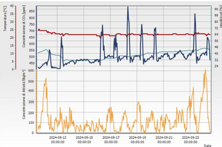
Esempio di un monitoraggio della concentrazione di Radon e di altri parametri con misuratore attivo.
