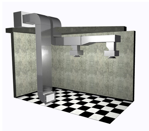
Canale con cassette di calma
