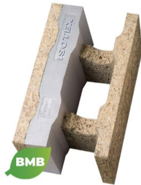
Blocco HDIII 30/7 con EPS grafite BASF-NEOPOR® U = 0,34 W/m 2 K
