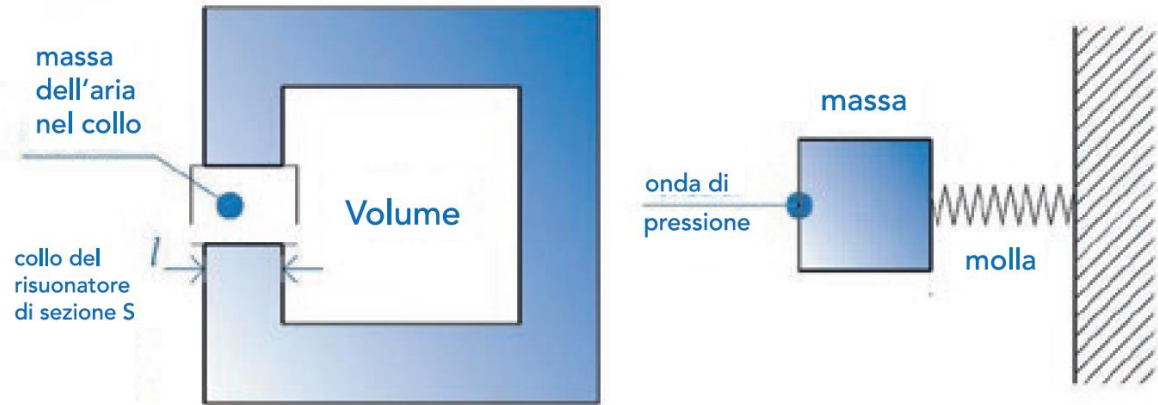
Schema e principio di funzionamento di un risuonatore acustico
