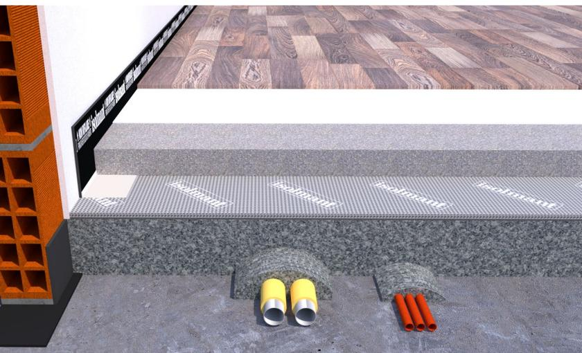
**POSA FLOTTANTE DI PAVIMENTO IN LAMINATO**
