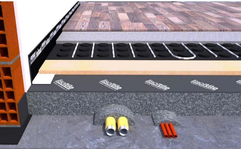
**STRUTTURE CON ISOLANTE TERMICO INTEGRATO
