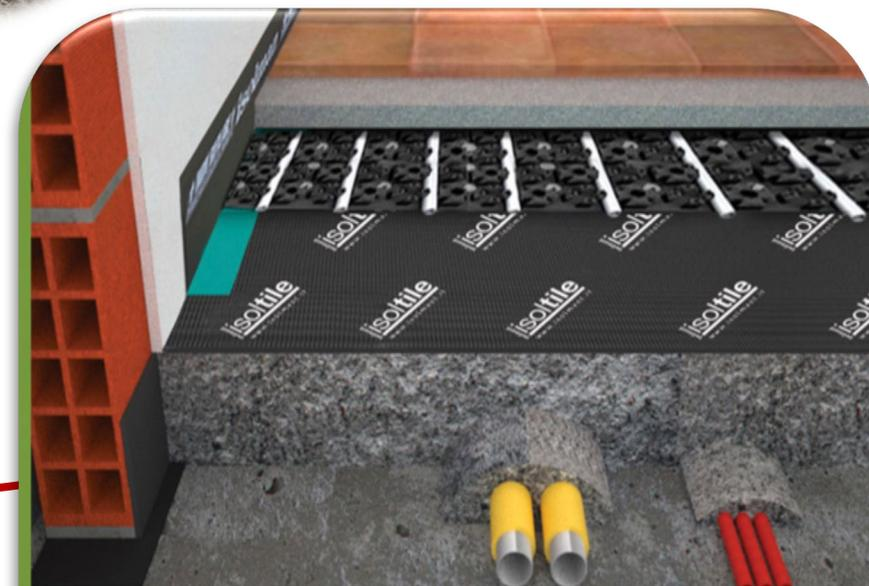
STRUTTURA CON RISCALDAMENTO A PAVIMENTO
