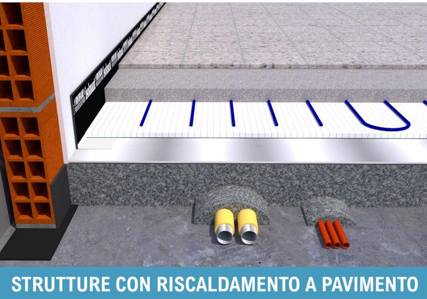
**STRUTTURE CON RISCALDAMENTO A PAVIMENTO**
