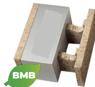
Blocco HDIII 44/20 con EPS grafite BASF-NEOPOR® U = 0,157 \text{ W/m}^2\text{K}
