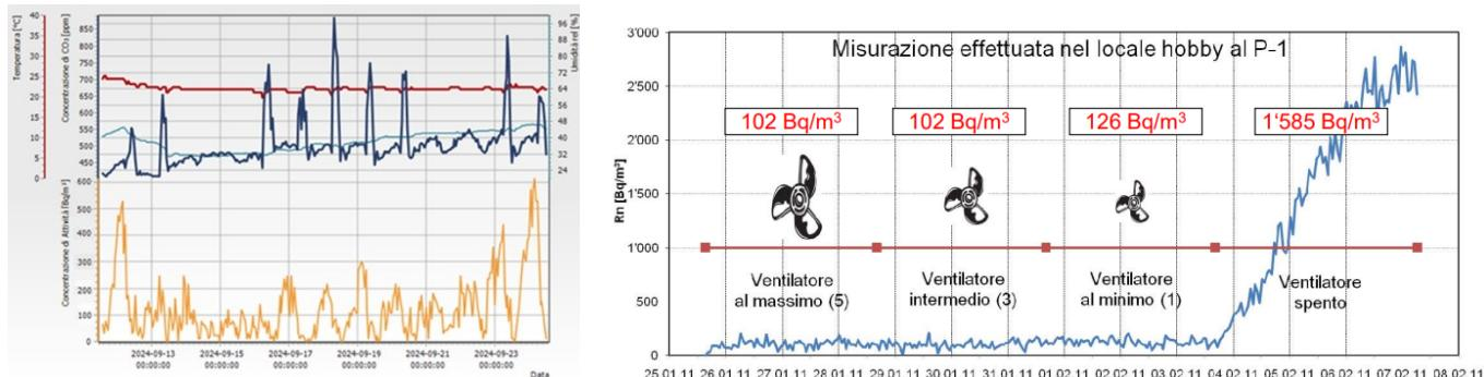
Esempi di un monitoraggio della concentrazione di Radon e di altri parametri con misuratore attivo.
