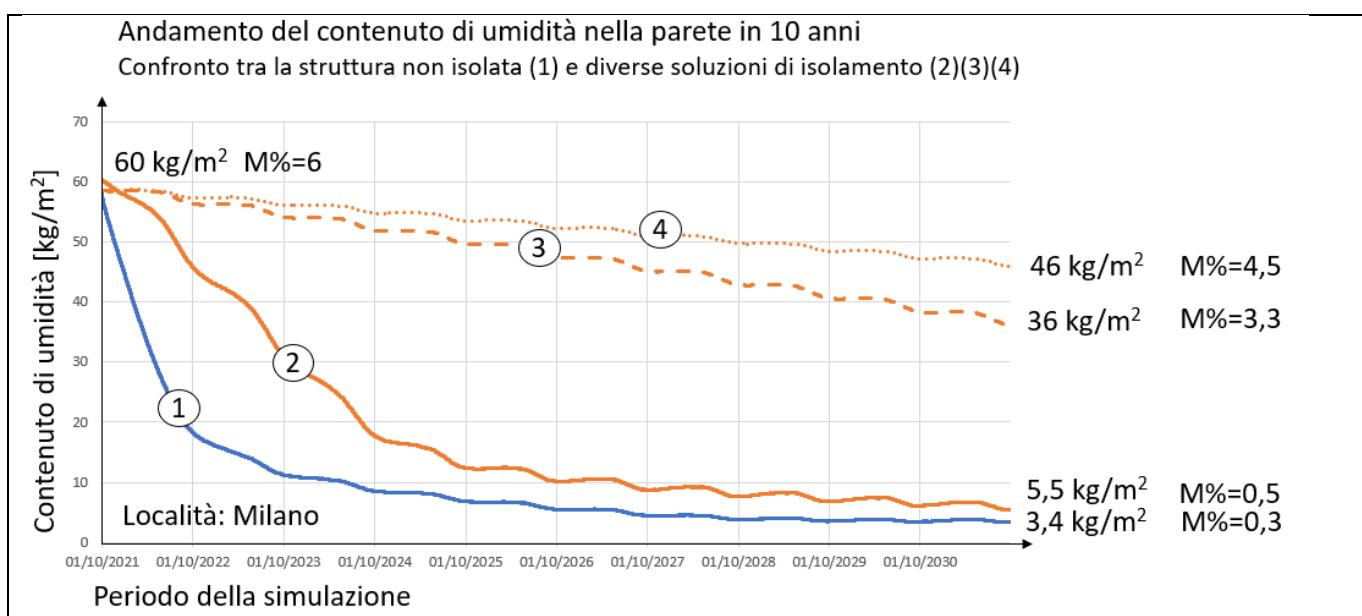
Esempio: questo grafico mostra la simulazione di una stratigrafia con metodo igrotermico dinamico orario, mettendo a confronto 4 ipotesi differenti e l'andamento del contenuto di umidità nella struttura per un periodo di 10 anni.
