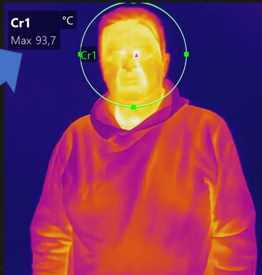
Emissività errata alluminio – 0,1
