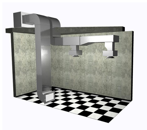
Ductos con cámaras de calma
